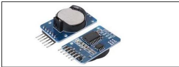
Gambar 2. Modul RTC DS3231
