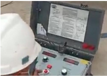
Gambar1. Peralatan DC Hipot yang digunakan pada pengujian isolasi kabel tegangan menengah
