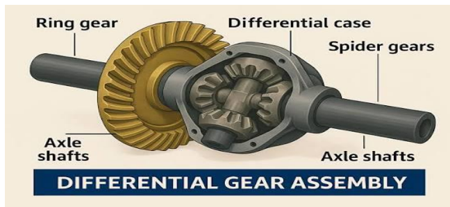
Gambar 2. Susunan komponen utama pada differential gear assembly
