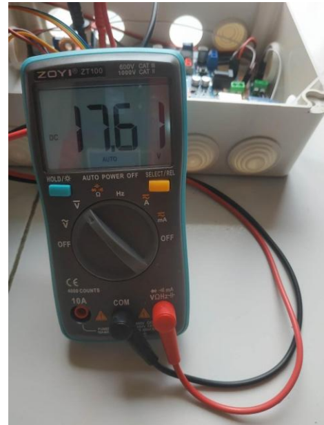
Gambar. 22 Pembacaan tegangan panel surya dengan multimeter
