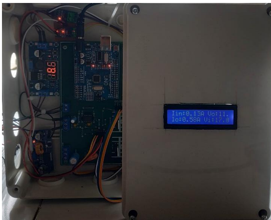
Gambar. 19 Pengujian LCD 16x2
