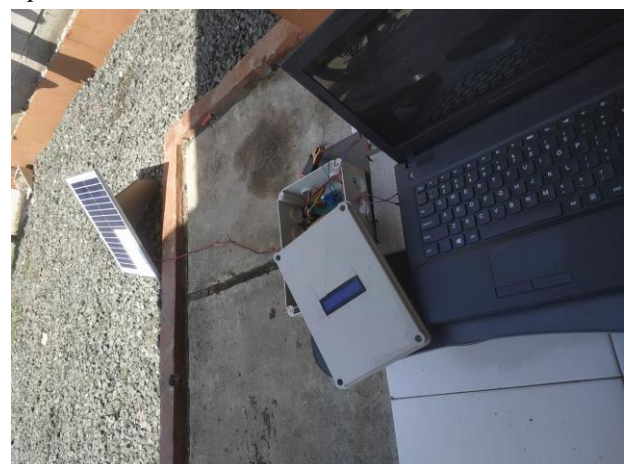
Gambar. 26 Permukaan panel surya ditutup 20%
