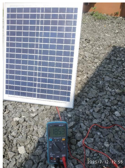
Gambar. 17 Pengukuran tegangan rangkaian terbuka (Voc)
