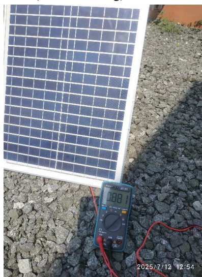
Gambar. 16 Pengukuran arus hubung-singkat (Isc)
