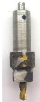
Gambar 4.27 Prototype Pahat Bor dengan Fungsi Dua Ukuran
