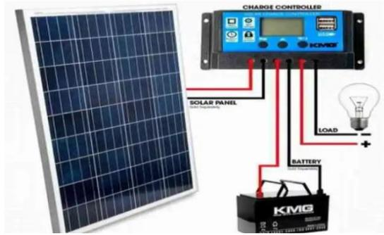
Gambar 4. Hubungan solar cell – SCC –Accu dan beban
