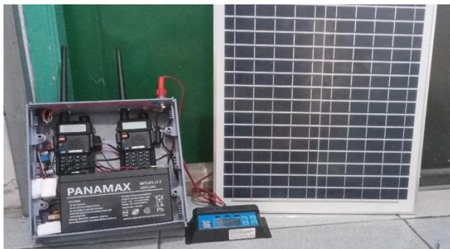
Gambar 11. Foto lengkap RPU dengan power solar
