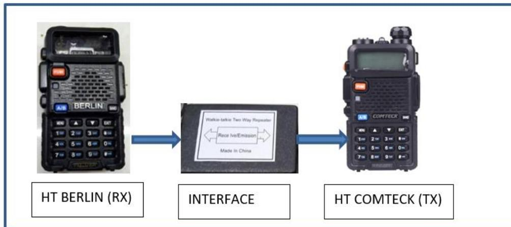
Gambar 6. Blok diagram *emergency repeater* mini
