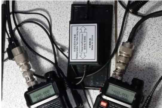
Gambar 8. Hubungan antar perangkat untuk RPU mini
