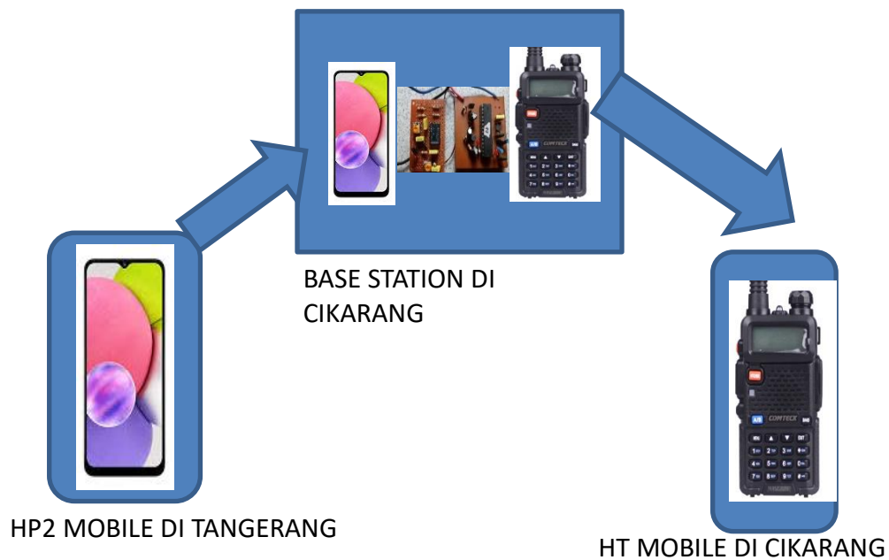
Gambar 13 Interkoneksi pada sistem RoWA satu HT TX/RX
